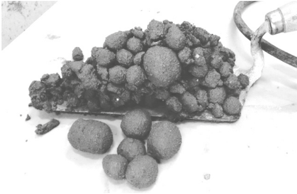
Figura 3 - Tamanho das esferas de concreto.
