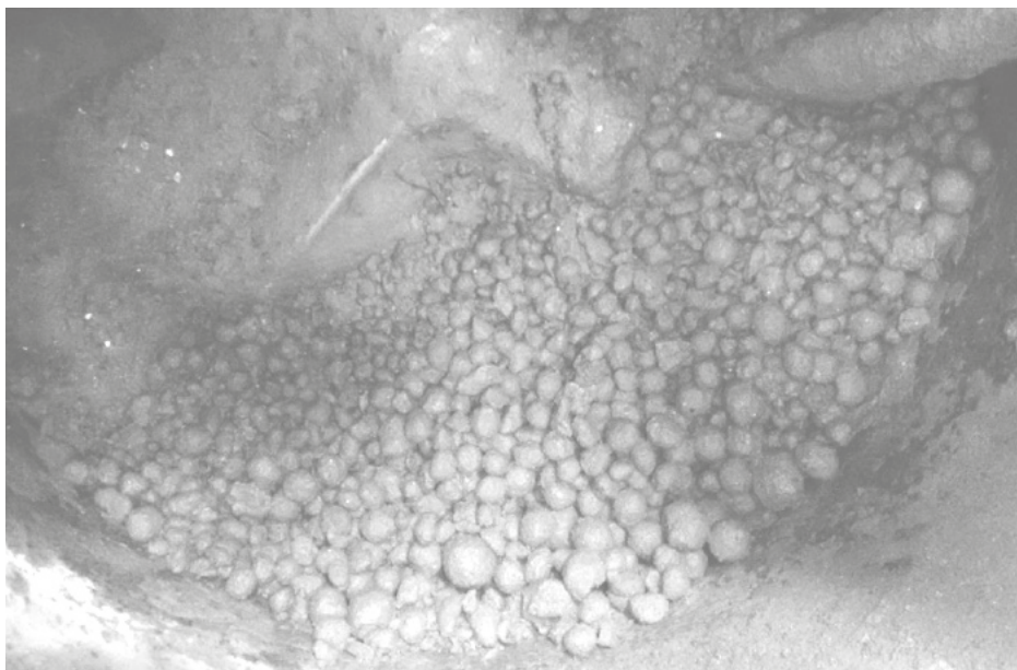
Figura 2 - Esferas de concreto no interior da betoneira.
