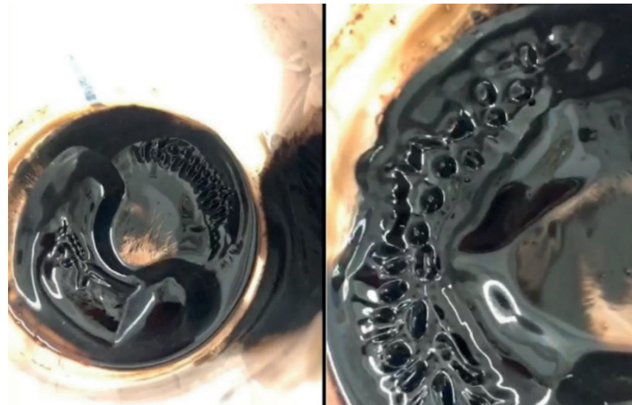
Figura 10. “Porco Espinho” das NPM após recobrimento com ácido cítrico.
