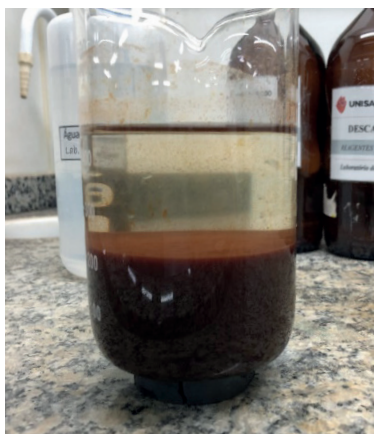
Figura 9. Oxidação da magnetita para maghemita com tratamento térmico.
