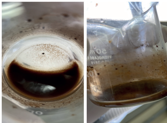
Figura 8. NPM oxidadas após armazenadas por um curto período.
