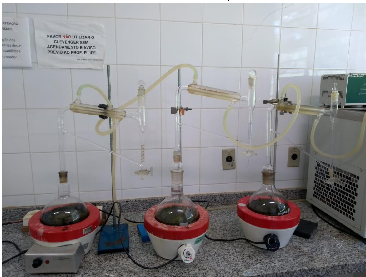
Figura 2. Sistema de extração em série: Aparelho tipo Clevenger modificado acoplado a balão de fundo redondo com manta de aquecimento.
