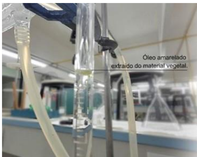
Figura 8. Sistema de extração aparato tipo Clevenger
